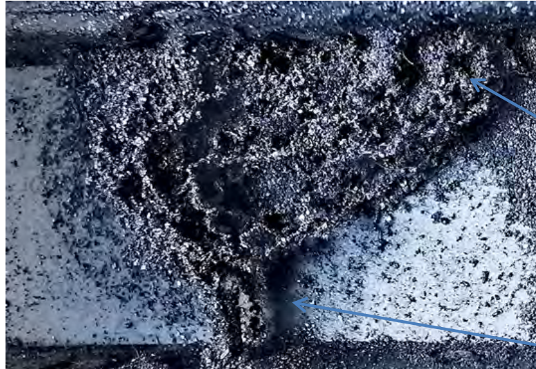
Рис.3. Древоподобная порошковая структура, сформированная мультиэлектродной системой
