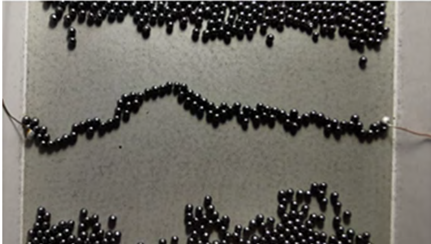
Проводящая двумерная дорожка, сформированная импульсным током
