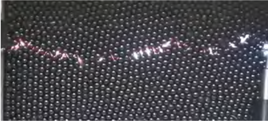
Рис.2. Кадр скоростной съемки процесса формирования проводящего канала
