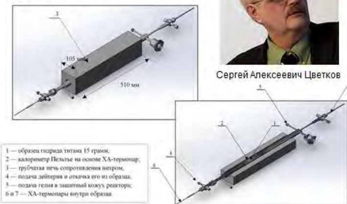
Первая экспериментальная установка для получения реакций ядерного синтеза в дейтерированном титане (апрель 1989 г.)
